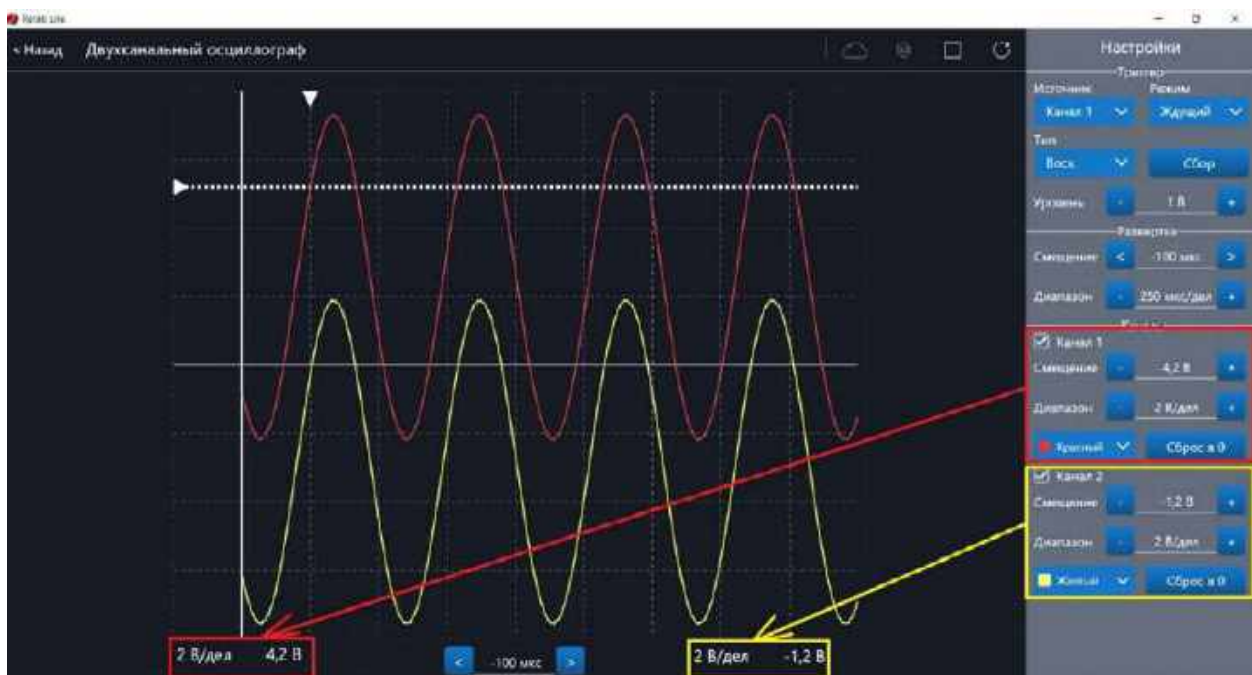
Рис. 39. Использование блока Каналы
